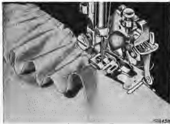
Fig. 107 - Formazione di creste con attaccatura simultanea.
