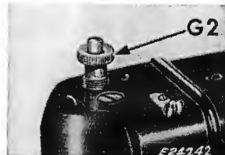
Fig. 25 - Vite a bottone per la regolazione della pressione sul piedino.
