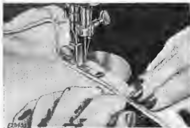
Fig. 98 - Imbastitura del cordoncino rivestito sull'indumento.
