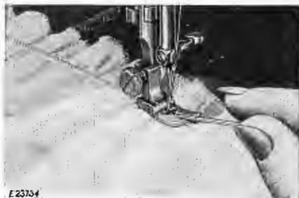
Fig. 51 - L'increspatura con filo elastico sovrapposto in esecuzione.
