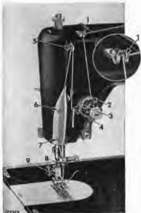
Fig. 5 - Per infilare la macchina dal di sopra.
