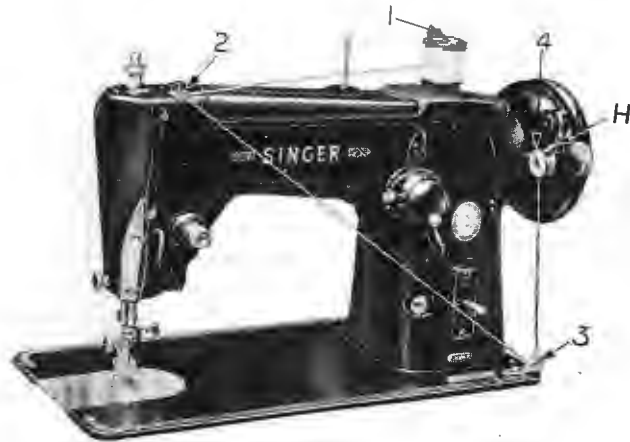
Fig. 10 - Per riempire la bobina.
