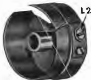
Fig. 30 - Tensione del filo della bobina.
