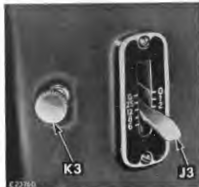
Fig. 20 - Per regolare la lunghezza del punto.
