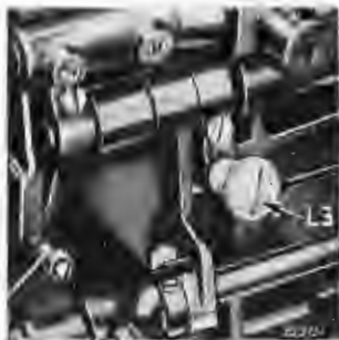
Fig. 70 - Per abbassare la griffa.
